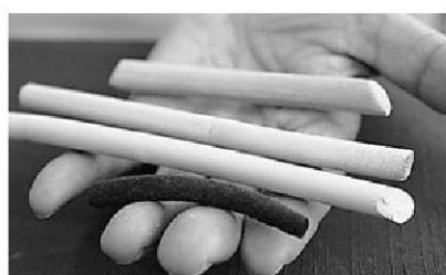
多孔性素材は消波ブロックがつながったような構造で、空洞が連続しているのが特徴。同社は多孔性樹脂製品を開発・製造している。
